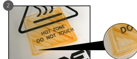
ギャップが狭い場合、吐出されたフィラメントがかすれてしまいます。また、エクストルーダー部で送り出されるフィラメントが、ギャップが狭いために適正量が吐出されずノズル内に残り、ギアの部分で滑りが発生します。その際に「コト…コト…」のような音がギア付近から出ます。
