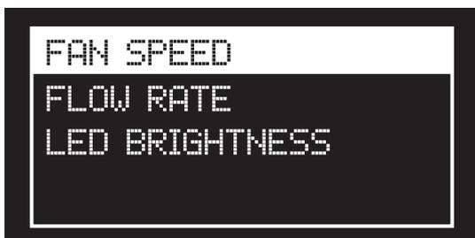
Fan speed: フィラメント冷却用ファン(プリントヘッド下部)の回転速度が変更出来ます。
