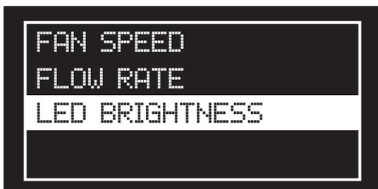
LED brightness: 本体内部造形スペースのLED照明の明るさが変更できます。
