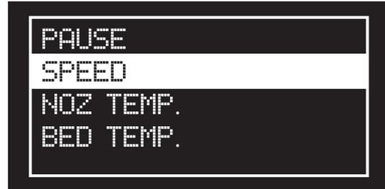
Speed: プリント中のヘッドの移動・プリント速度を変更できます。
