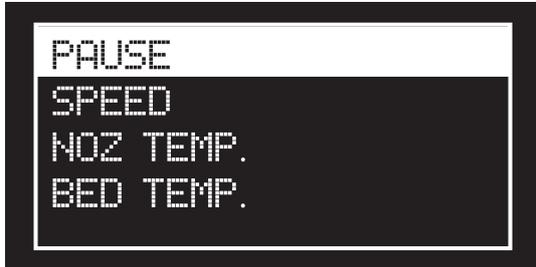
Pause: 一時停止します。加熱パッドが少し下がり、プリントパッドが左手前に移動します。
