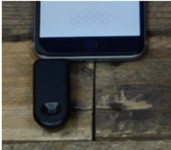
**Bevel** を設置した状態で端末を均等な場所に置いて、キャリブレーションカードを使ってアプリの指示通りに携帯カメラのキャリブレーションを行って下さい。
