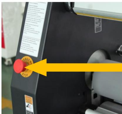
本機左側キャビネットに赤い非常停止スイッチがあり、押すと直ちに電源が切れます。時計方向に回すとスイッチが自動的に押し出され、電源がオン状態に戻ります。巻き戻し動作を行いたい場合は、メイン操作パネルの電源スイッチで再起動してください。非常停止スイッチは重要な安全機能ですので、機能を定期的に点検してください。
