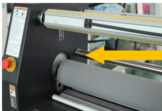
フィルムガイドバーの主な役割は、「S」字形に曲がったフィルムがゴムローラーの間をできる限り滑らかに通過させることにあります。これにより、高品質なラミネート結果が得られるようになります。
